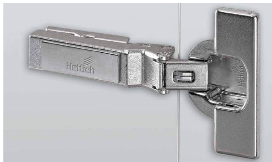
W-30 full overlay negative angle hinge (opening angle 125°, for -30° face angle) W-30 Negativ-Winkelscharnier voll vorliegend (Öffnungswinkel 125°, für Korpuswinkel -30°)
