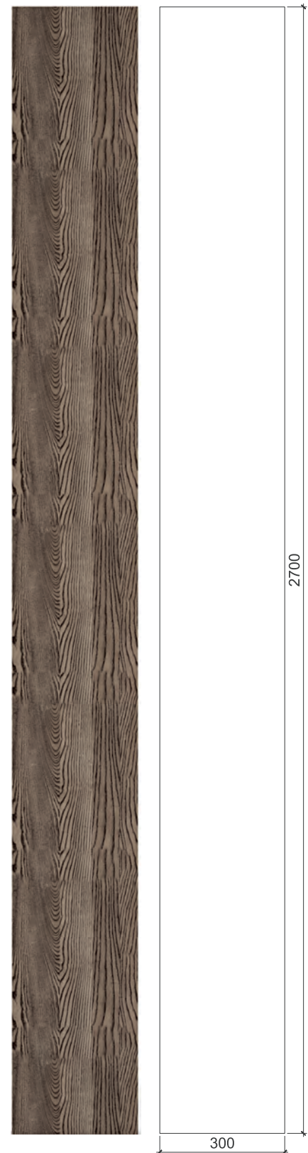
Декоративная панель (дверной проём) (шпонированная МДФ 7мм) Decorative panel (doorway) (veneered MDF 7mm)
